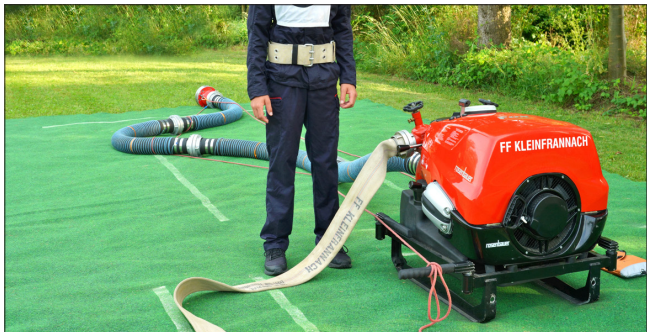
Abb. 41: Richtiges Ablegen einer fertigen Saugschlauchleitung (LFV Stmk. BR d.V. Franz Fink)
