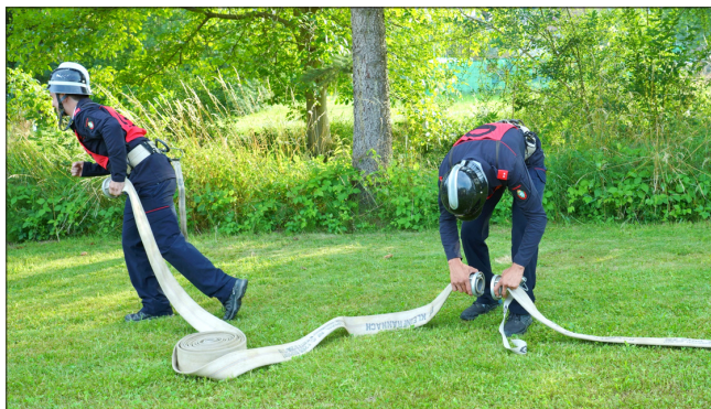
Abb. 43: Ankuppeln und Auslegen des zweiten B-Schlauches (LFV Stmk. BR d.V. Franz Fink)
