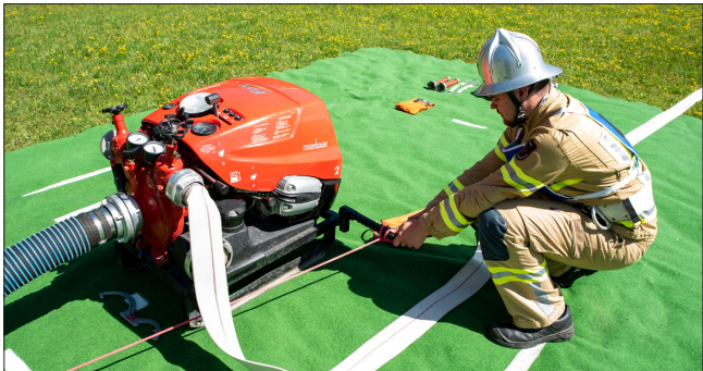
Abb. 39: Richtiges Befestigen der Saugschlauchleine (LFV Tirol)
