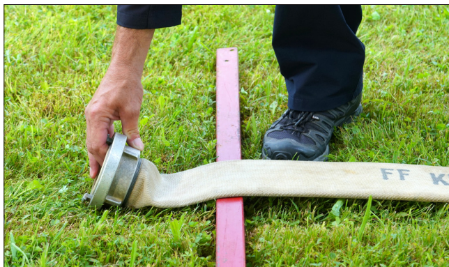
Abb. 44: Richtiges Ablegen der Kupplung des zweiten B-Schlauches (LFV Stmk. BR d.V. Franz Fink)
