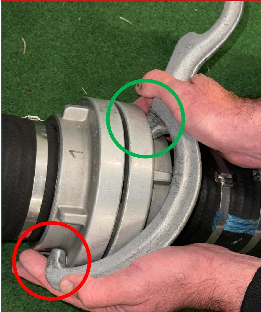
**Fehler**, weil nur eine „Nase“ des Kupplungsschlüssels die „untere Fläche der Kupplung“ berührt
