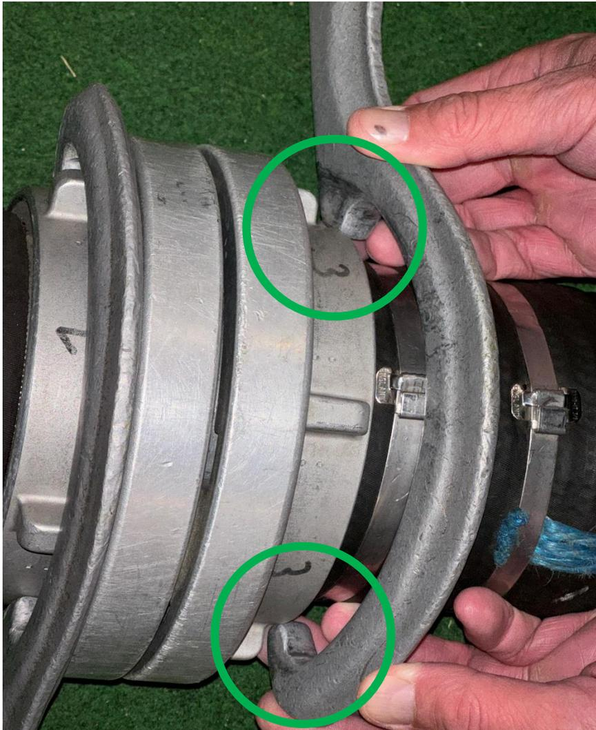
kein Fehler, weil beide „Nasen“ des Kupplungsschlüssels die „untere Fläche der Kupplung“ berühren
