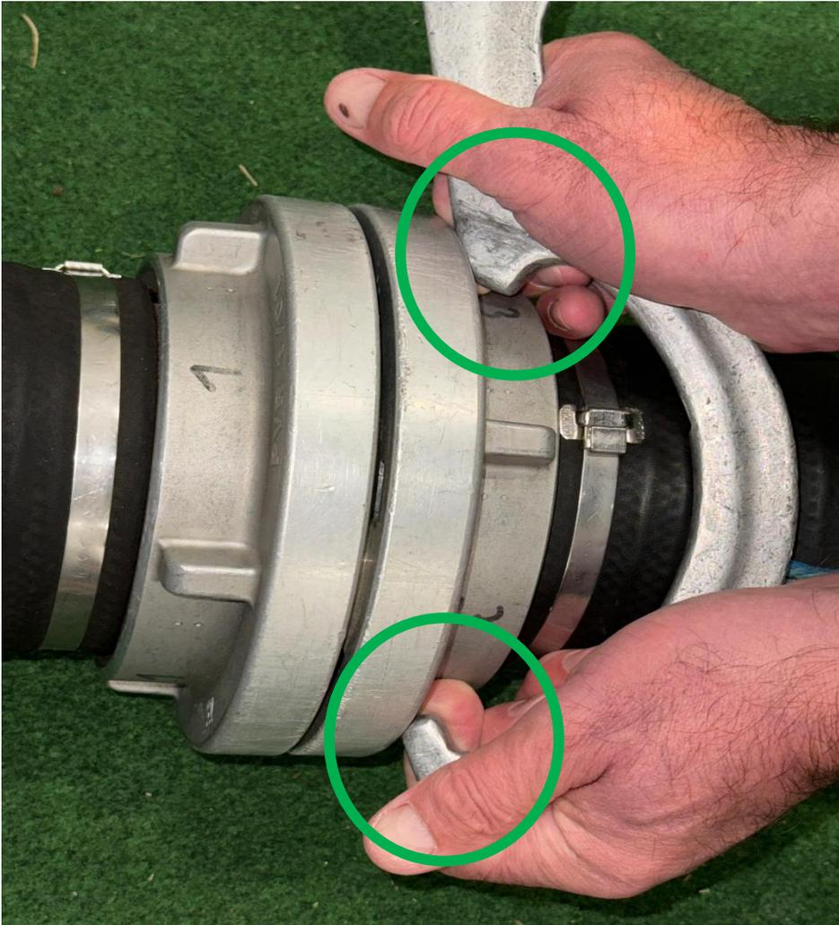
kein Fehler, weil beide „Nasen des Kupplungsschlüssels die „untere Fläche der Kupplung“ berühren
