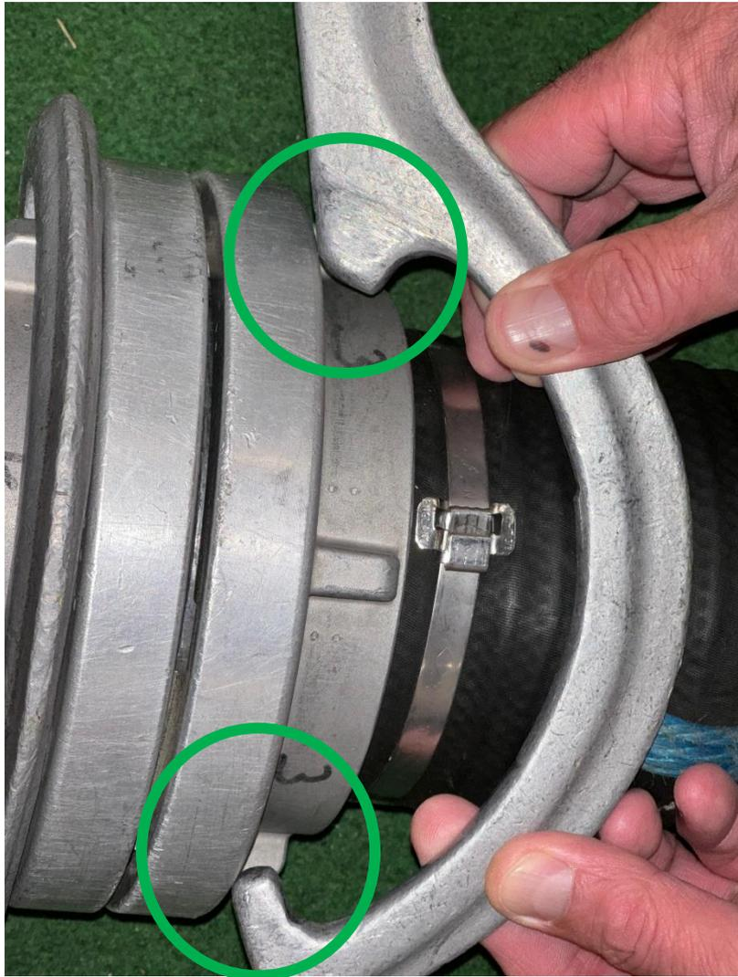
kein Fehler, weil beide „Nasen“ des Kupplungsschlüssels die „untere Fläche der Kupplung“ berühren
