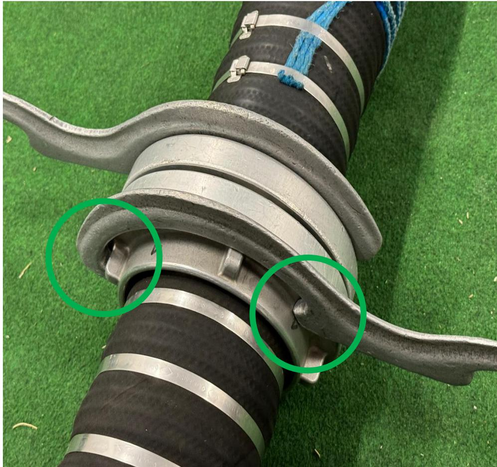
kein Fehler, weil beide „Nasen“ des Kupplungsschlüssels die „untere Fläche der Kupplung“ berühren
