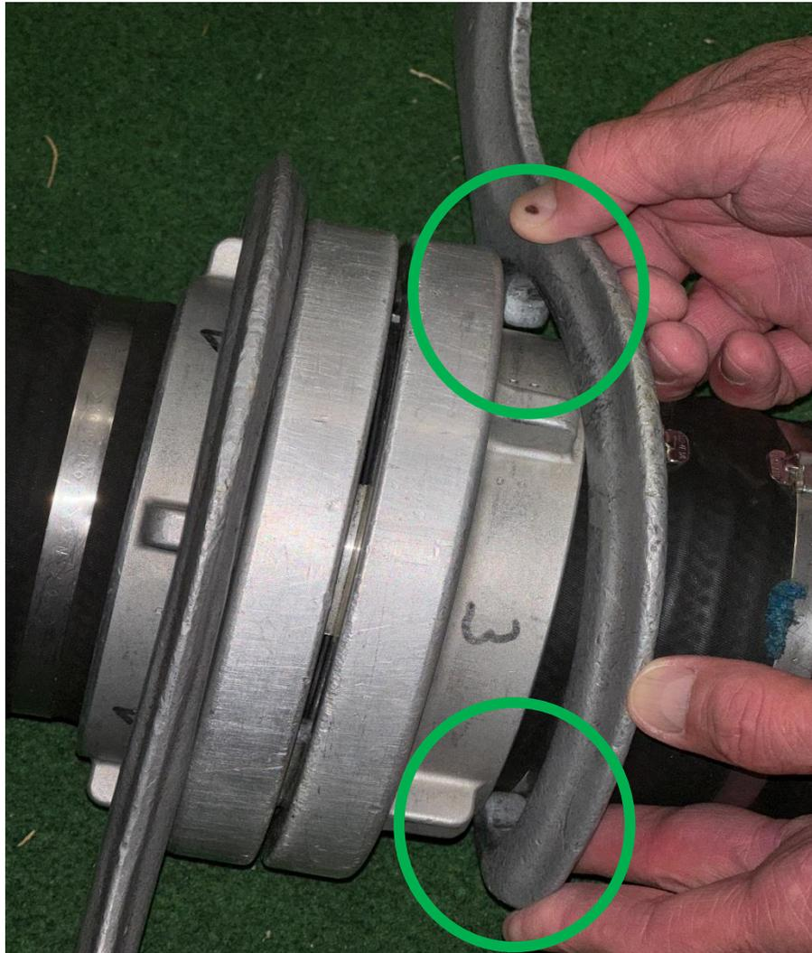
kein Fehler, weil beide „Nasen“ des Kupplungsschlüssels die „untere Fläche der Kupplung“ berühren
